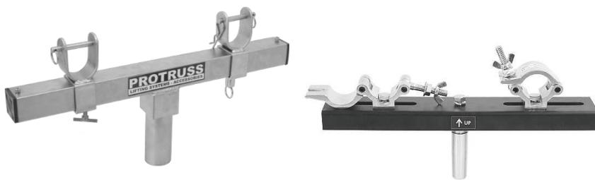
Su elevatori di illuminazione più grandi, i **tralicci "Americana"** possono essere fissati alla parte superiore dei supporti per l'illuminazione utilizzando "adattatori traliccio" che sono fabbricati con un perno TV, una barra orizzontale e morsetti che afferrano il traliccio.
