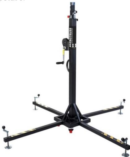
**Supporti con verricello** - Questi elevatori sono sollevabili con poche centinaia di chilogrammi fino a circa 6 m. Hanno sistemi di frenatura sicuri e un ampio "ingombro" (la dimensione della base) per una buona stabilità. Vista la grande altezza di elevazione, i supporti hanno piedini regolabili per consentire loro di essere eretti in sicurezza garantendo che siano verticali.
